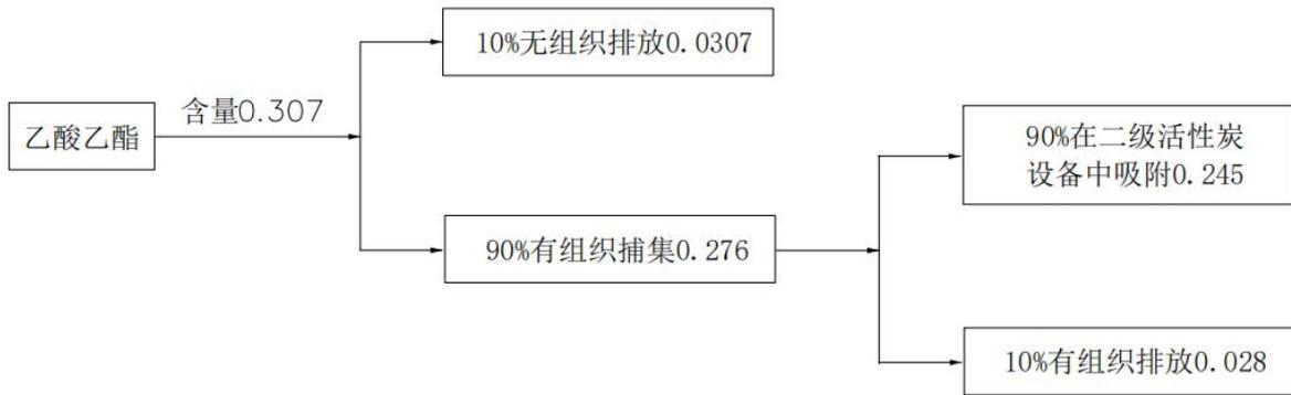
图 2-1 乙酸乙酯物料平衡图 单位: t/a
