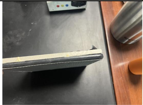
产品示意图（共有 3 层，底层为纤维水泥毡，中间层为真空绝热板，上层为碳酸钙板，碳酸钙板上覆装饰面层为非金属装饰一体板，覆金属壳为金属装饰一体板）
