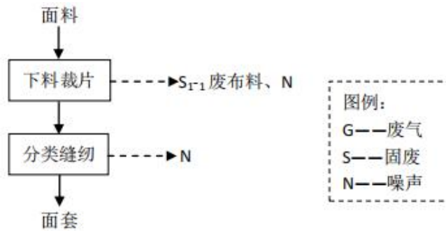
图 3.3-1 面套生产工艺流程及产污环节图
